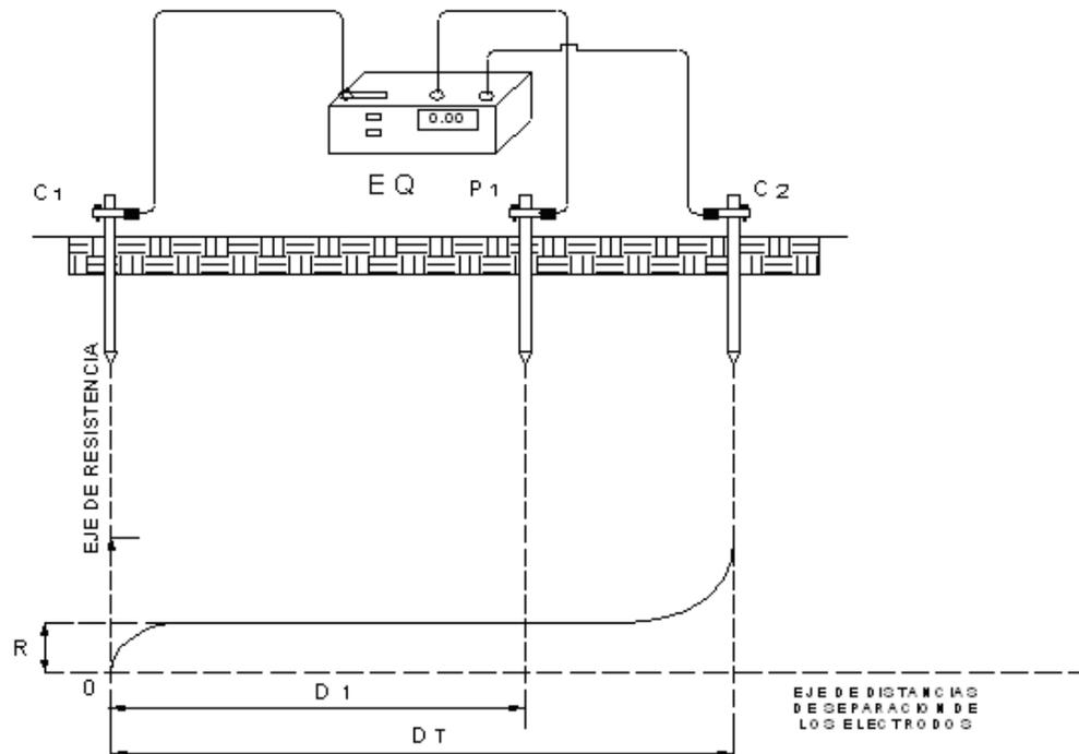
**D1** Distancia entre el electrodo de la red de puesta a tierra C1 y el electrodo auxiliar P1.
